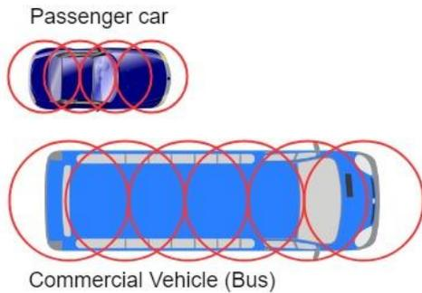
**FIGURE 2:** VEHICLE GEOMETRY LAYOUT FOR TTC COMPUTATION [12].
